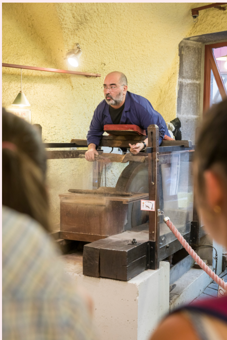
Démonstration d'émouture à la planche au sein des ateliers du musée de la Coutellerie (en bas) et support de médiation (en haut) © musée de la Coutellerie, Ville de Thiers
